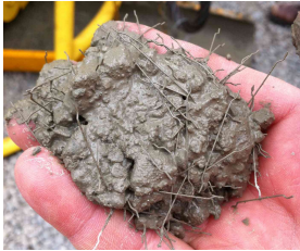
Concreto fresco con fibras de acero (20–60 mm).
